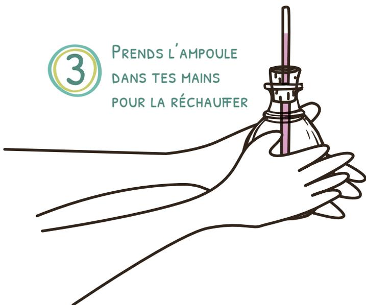
APRÈS QUELQUES SECONDES L'ALCOOL COMMENCE À MONTER À L'INTÉRIEUR DE LA PAILLE EN ARRIVANT À LA REMPLIR PRESQUE COMPLÈTEMENT!!
